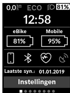
Op het statusscherm krijgt u naast de statusbalk de actuele tijd, de laadtoestand van alle accu's van uw eBike en de laadtoestand van uw smartphone-accu te zien, als de smartphone via *Bluetooth®* is verbonden. Daaronder worden evt. symbolen voor de aanduiding van een geactiveerde *Bluetooth®*-functie of een via *Bluetooth®* verbonden toestel (bijv. een hartslagmeter) afgebeeld.
