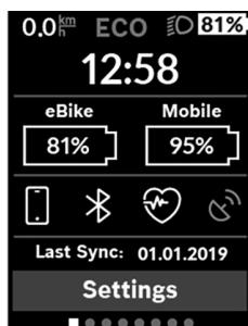
I statusskjerm bildet vises statuslinjen, og i tillegg gjeldende klokkeslett, ladenvået til alle batteriene til Bike og smarttelefonbatteriet hvis smarttelefonen er koblet til via Bluetooth®. Under denne vises eventuelt symboler for en aktivert Bluetooth®-funksjon eller en enhet som er koblet til via Bluetooth® (for eksempel en pulsølger). I tillegg vises datoene for den siste synkroniseringen mellom smarttelefon og Kiox.
