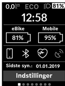
På statusskærmen får du ved siden af statuslinjen vist det aktuelle klokkeslæt, ladetilstanden for alle din eBikes akkuer og ladetilstanden for dit smartphone-batteri, hvis din smartphone er forbundet via **Bluetooth®**.
