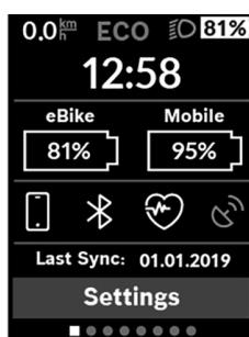
Στην οθόνη κατάστασης εμφανίζονται εκτός από τη γραμμή κατάστασης η τρέχουσα ώρα, η κατάσταση φόρτισης όλων των μπαταριών του eBikes σας και η κατάσταση φόρτισης της μπαταρίας του smartphone σας, σε περίπτωση που το smartphone είναι συνδεδεμένο μέσω Bluetooth®.
