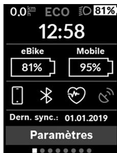
Le masque d'état affiche, en plus de la barre d'état, l'heure actuelle, le niveau de charge de toutes les batteries de votre vélo électrique et l'état de charge de l'accu de votre smartphone si le smartphone est connecté via Bluetooth®. En-dessous apparaissent éventuellement les symboles indiquant qu'une connexion Bluetooth® est active ou qu'un appareil (par ex. un cardiofréquencemètre) est
