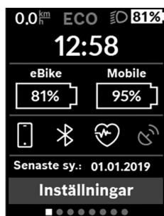
På statusskärmen visas bredvid statusraden även aktuellt klockslag, laddningsnivå för alla batterier på din eBike samt laddningsnivå för din smarttelefon, om den är ansluten via Bluetooth®. Under detta visas ev. symboler för aktiverad Bluetooth®-funktion eller enheter som är anslutna via Bluetooth® (t.ex. en pulsämätnare). Dessutom visas
