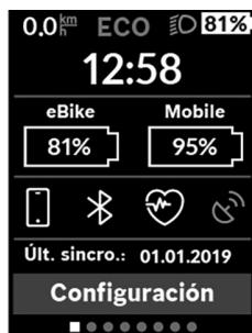
Además de la barra de estado, la pantalla de estado muestra la hora actual, el estado de carga de todos los acumuladores de su eBike y el estado de carga de la batería de su smartphone, en caso de que esté conectado a través de Bluetooth®.
