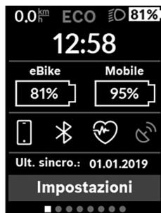
Nella schermata di stato vengono visualizzati, oltre alla barra di stato, l'ora attuale, il livello di carica della batteria dell'eBike e il livello di carica della batteria del vostro smartphone, qualora lo smartphone sia collegato via Bluetooth®.
